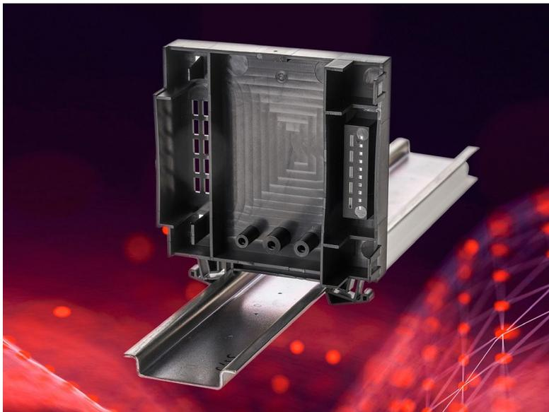
Zu Testzwecken stellt LANXESS anwendungsnahe Bauteile her. Mit einem eigens entwickelten E&E-Versuchswerkzeug untersucht das Unternehmen typische Herausforderungen beim Spritzgießen seiner flammgeschützten oder auch hydrolysestabilisierten Compounds und gibt Verarbeitern Empfehlungen für die Serienproduktion.
